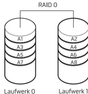
RAID 0 verwendet die volle Speicherkapazität beider Laufwerke. Beispielsweise wird durch die Kombination von zwei 2 GB-Festplatten ein Festplattenspeicher von 4 GB für das Speichern von Daten bereitgestellt.
