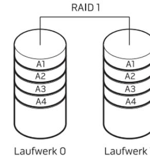
Wenn ein Laufwerk ausfällt, werden die Lese- und Schreib-Vorgänge an das verbleibende intakte Laufwerk übertragen. Ein Ersatzlaufwerk kann aus den Daten des verbleibenden intakten Laufwerks erstellt werden.
