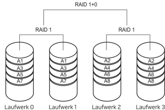
Wenn es zu einem Laufwerksausfall kommt, werden alle weiteren Lese- und Schreibvorgänge auf die funktionierenden Laufwerke übertragen. Anhand der Daten auf den verbleibenden Laufwerken kann dann ein Ersatzlaufwerk eingerichtet werden. Da die Daten außerdem auf dem primären und den weiteren Laufwerken dupliziert werden, ergeben vier 120-GB-Laufwerke insgesamt maximal 240 GB für die Datenspeicherung.
